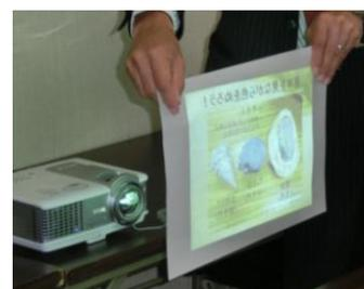
背面投影スクリーンはこのように、光を反射するのではなく、透過することで映像を表示するものです。透過光をみているので、映像の前に立っても影等はできず、この点が反射型よりすぐれています。
